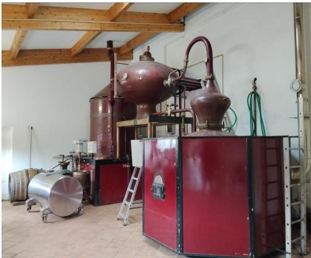
Il est encore beau notre alambic de 12 hl acheté d'occasion et installé en 1993. La gestion du refroidissement de l'eau dans la pipe vient d'être restaurée .
